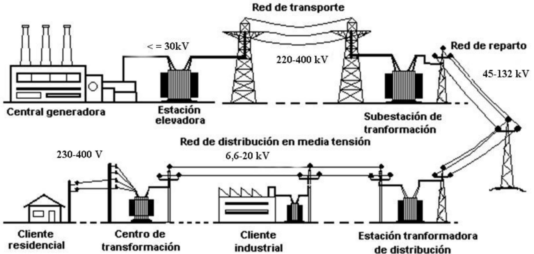
*Esquema simplificado del sistema eléctrico de potencia en España*
