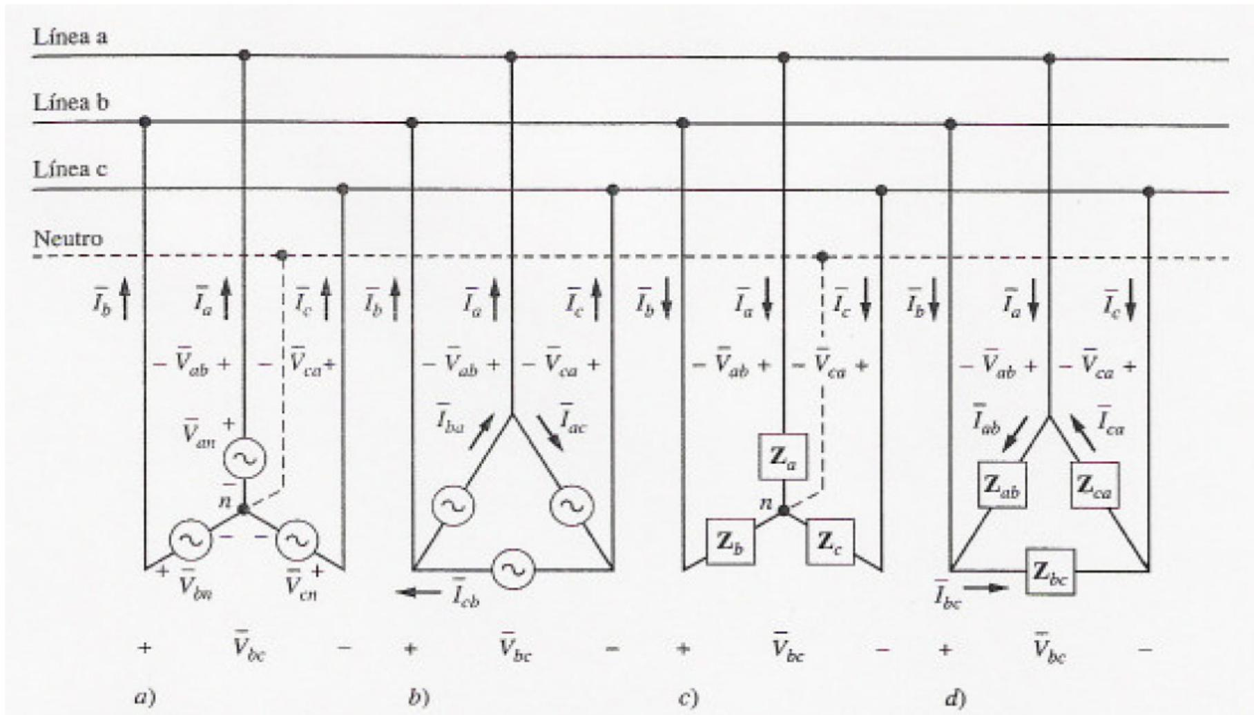
a) *Generador trifásico en estrella; b) Generador trifásico en triángulo*
