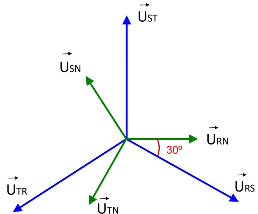
**Ejemplo 1.-** Un sistema trifásico, a la secuencia ABC, con una tensión de línea de 100 V eficaces, tiene conectada una carga en triángulo equilibrada con impedancias por fase  $20 \angle 45^\circ$ . Obtener las intensidades por cada conductor de línea y dibujar el diagrama fasorial de tensiones e intensidades.  $V_{BC} = 100 \angle 0^\circ$
