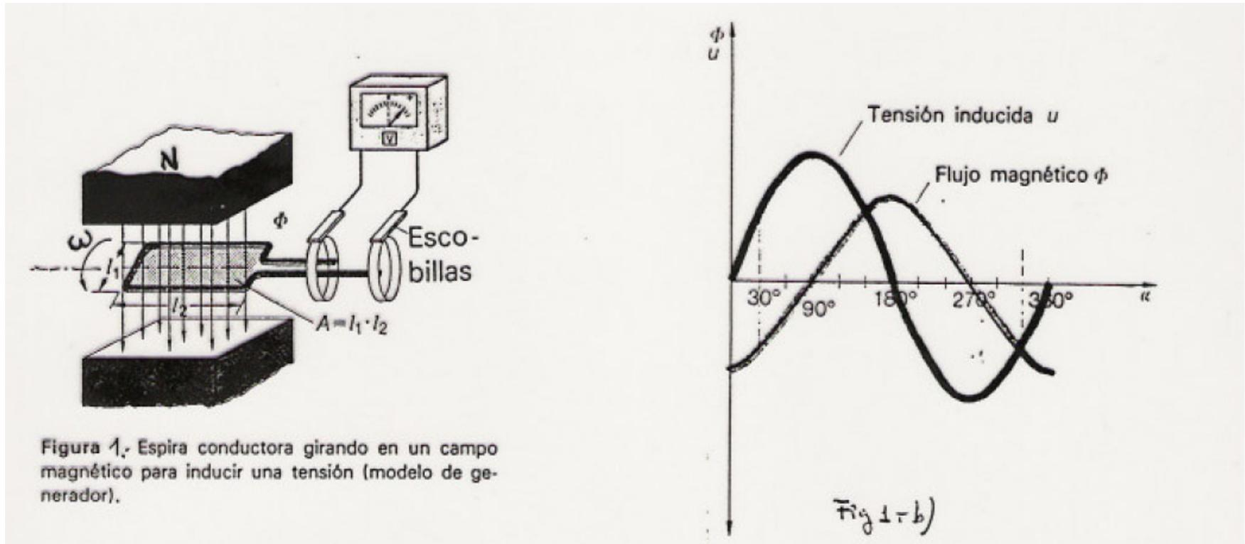
*Generador Monofásico con inductor fijo e inducido móvil.*
